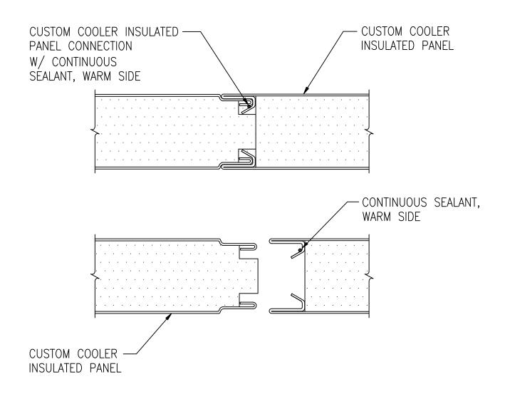
CUSTOM COOLER INSULATED PANEL TO PANEL MODEL CLP601 CONNECTION
